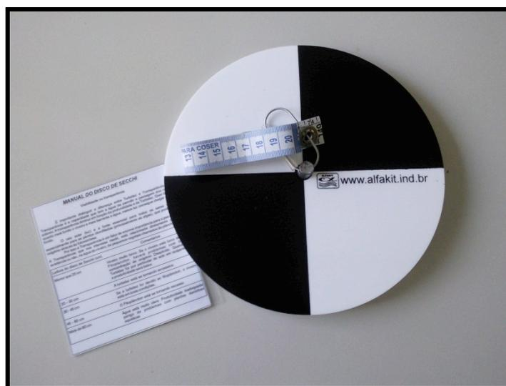
Fig. 6 Disco de Secchi para análise de turbidez.
