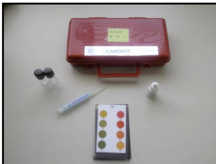
Fig.3 Kit para a análise de Potencial Hidrogeniônico (pH).
