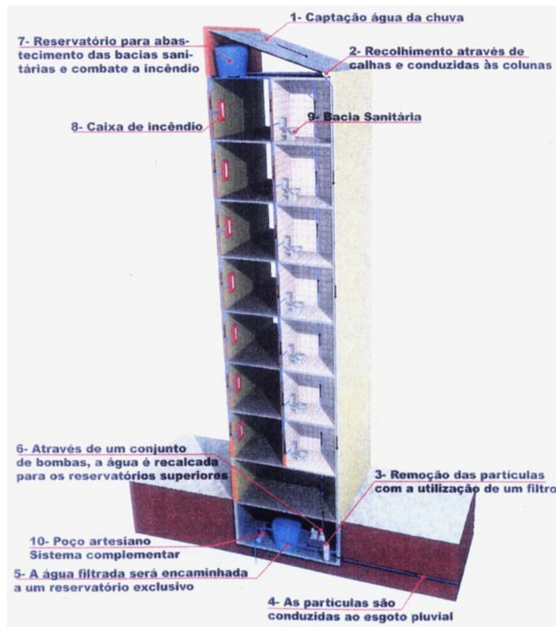
Fig.30 (Sistema de Uso da água das chuvas em sanitários de condomínios) Fonte: Case Premiun – Eng. Paulo Garcia/2004
